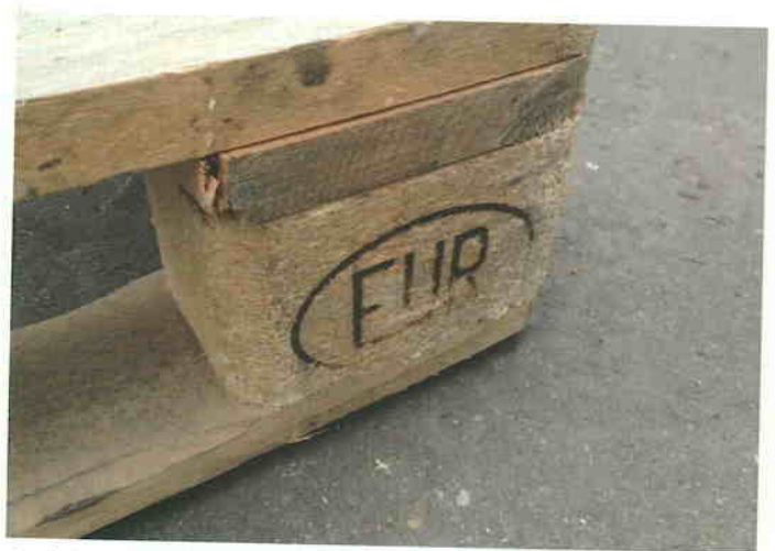
Auf dem oberen Bild befindet sich eine Pressspan-Europalette mit verhältnismäßig geringer Lastaufnahme, unten eine Vollholz-Europalette mit hoher Lastaufnahme.
